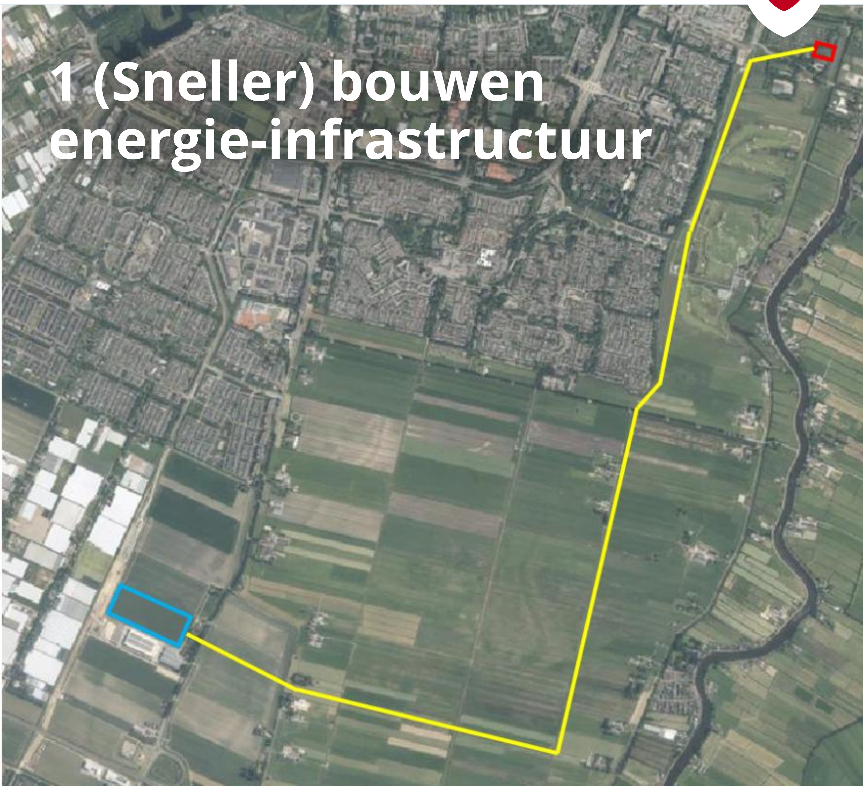
Figuur 1.1: uitbreiding hoogspanningsnet Amstelveen (globale ligging bestaand hoogspanningsstation met uitbreidingslocatie (rood omljnd), nieuw hoogspanningsstation (blauw omljnd) en kabeltracé (gele lijn), bron: Google Maps)
